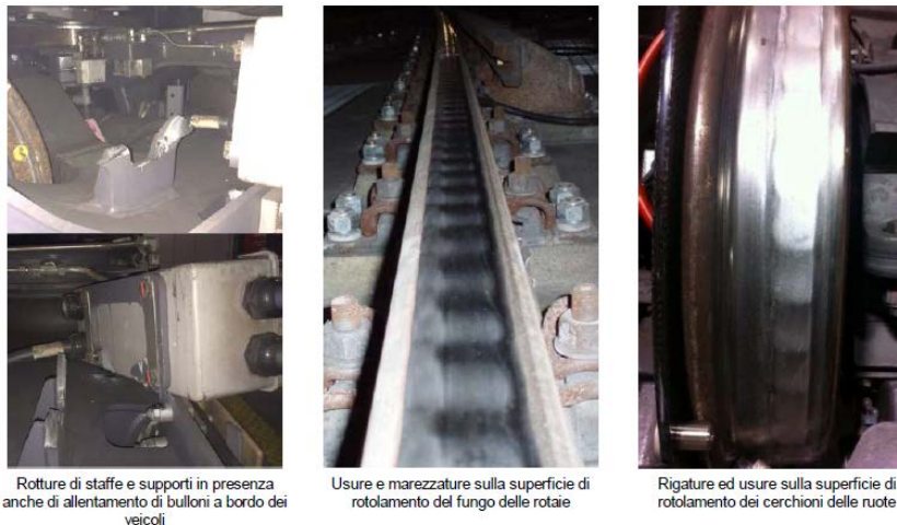
Figura 8. A volte il rutting è così importante da finire sui giornali (in alto, Corriere della Sera ed. Milano del 05.08.2015) e da provocare danneggiamenti estesi a veicoli ed infrastruttura (in basso, P. Pezzoli, RELAZIONE TECNICA Metropolitana di Milano Linea 5 (Garibaldi FS ÷ Bignami) Tratta Garibaldi ÷ Isola. Valutazione dei fenomeni di usure e marezzature delle superfici di rotolamento, doc. INDAPRO RT-2015-016-02.doc del 05.2015)
