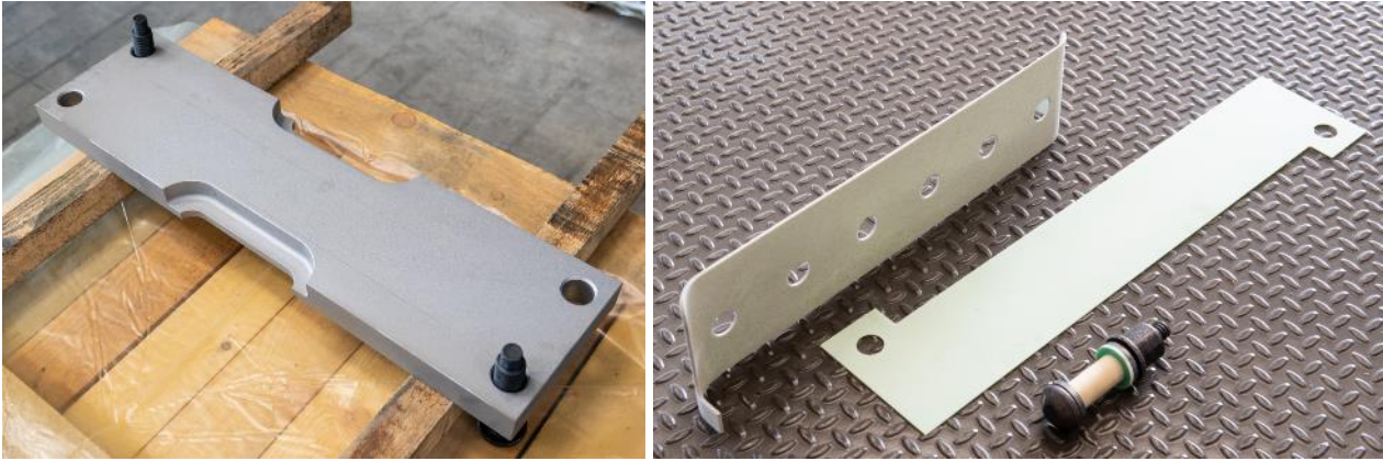
Figura 6. Piastra coprigiunto universale, per barre con forgiatura destra o sinistra (sinistra), chiodo Huck completo di collare, rosette e canotto ed elementi in vetroresina per l'isolamento dei delle due barre lavorate (destra)
