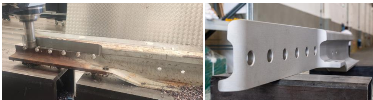
Figura 5. Fresatura della barra per ago (sinistra), barra per ago lavorata e sabbata in fase di montaggio (destra)
