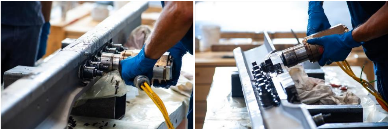
Figura 7. Serraggio dei chiodi Huck con pistola idraulica
