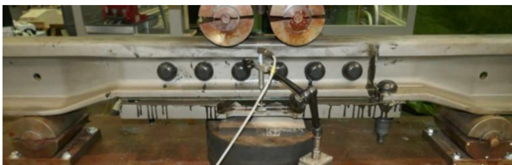
Figura 11. Prova di flessione sul giunto ABJ-009. Un trasduttore di spostamento è posizionato per monitorare l'abbassamento verticale del giunto durante l'intero arco della prova
